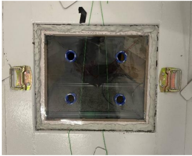
Rysunek 2: a) Prototyp metamateriału elastycznego umieszczony w oknie komory pogłosowej, b) Komora pogłosowa w LAT
